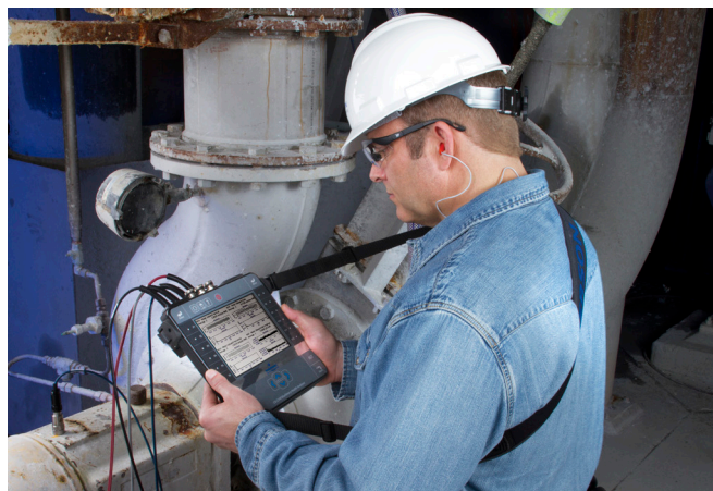
AMS 2140 机械状态分析仪在振动数据采集和现场分析的速度和性能方面堪称业界最佳。
