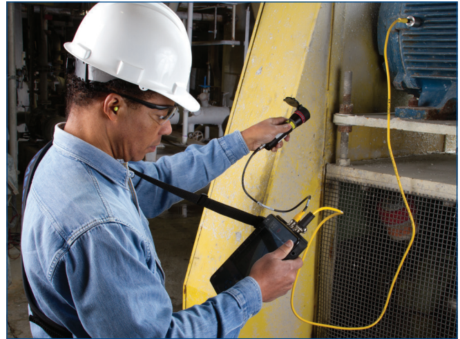
AMS 430 激光转速计在不用关停设备的情况下测定轴的转速——甚至是在空间非常狭小的位置。
